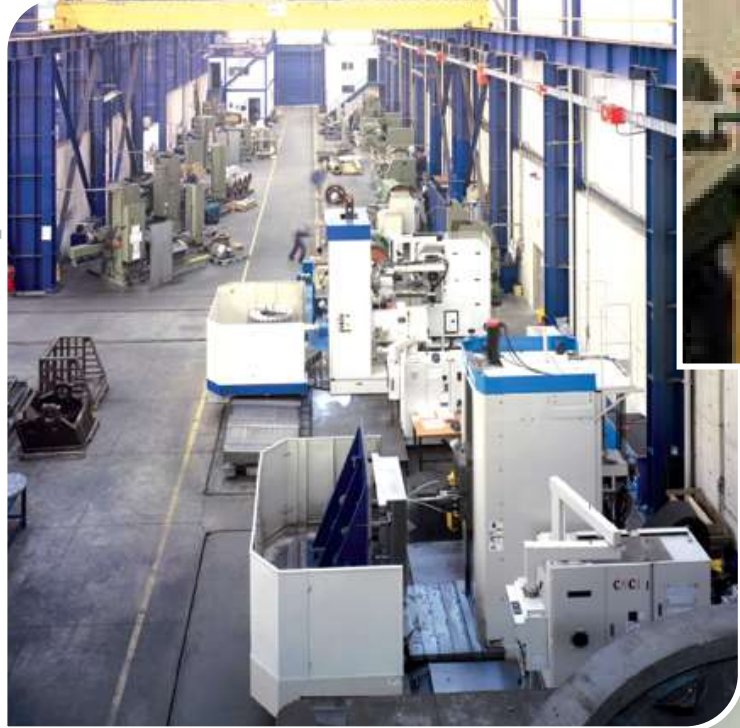
CNC BOHRWERK TEZGAHI X : 7000 Y : 3000 X : 3000 Y : 2000 X : 2000 Y : 2000
