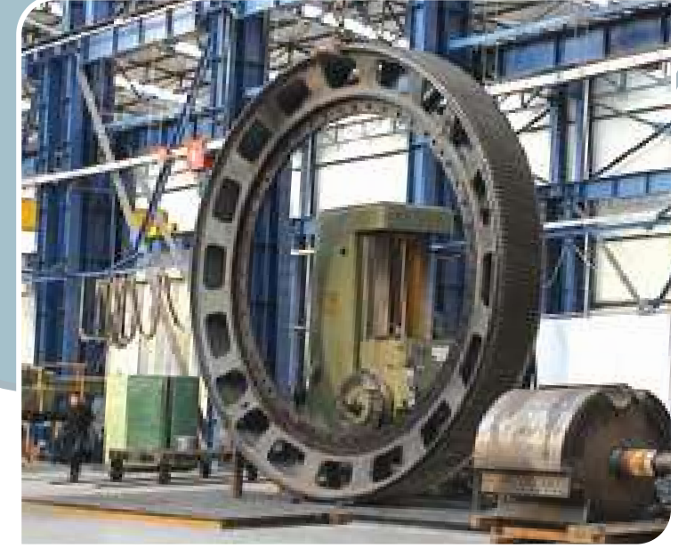
FENER DİŞLİ Ø : 5400 m : 30 (Set Çimento - Ankara fabrikası)
