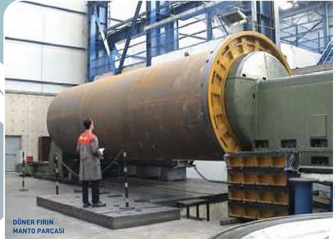
FENER DİŞLİ Ø : 5400 m : 30 (Set Çimento - Ankara fabrikası)
