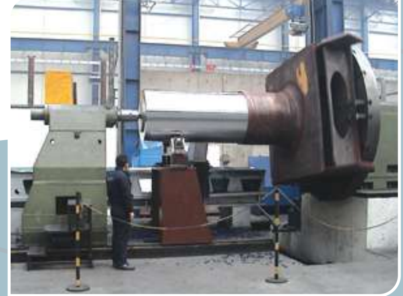
CNC PLAN PUNTA TORNA TEZGAHI Ø : 4400 L : 12000
