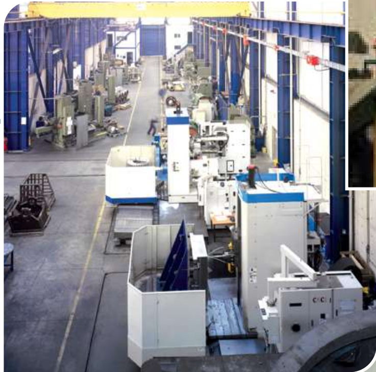
CNC BORING MACHINE X : 7000 Y : 3000 X : 3000 Y : 2000 X : 2000 Y : 2000
