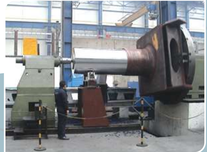
CNC LATHE Ø : 4400 L : 12000
