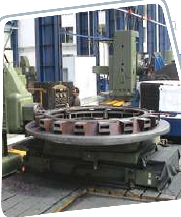
BORING MACHINE X : 6500 Y : 2500 X : 9000 Y : 1800
